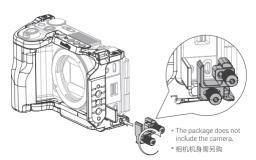
Step 3: Insert the cable and tighten the thumbscrews to secure the cable. 第三步: 插入线材,通过手拧螺丝锁紧固定线材。
