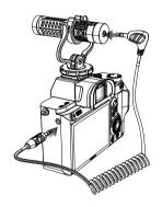
4.取出3.5mm TRS 音频线,连接S20的3.5mm麦克风输出接口、录制设备的3.5mm麦克风输入接口。
