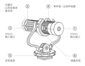
3.5mm TRS 输出接口:通过此接口,将 S20 连接到您的录音设备如单反相机/摄像机/手机。S20将为您的录音设备进行拾音。
