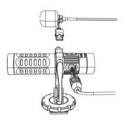
如果您想获得全面 / 专业的立体声效果,请将外置麦克风(如附赠的领夹麦克风)接入3.5mm麦克风输入接口,并将模式按键滑动至 "S",此时你可以进行立体声录制,更适用于录制可后期处理的立体声音熵。
