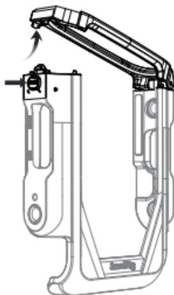
Étape 2 : Alignez la caméra avec la cage ① et y insérer la caméra avec soin.
